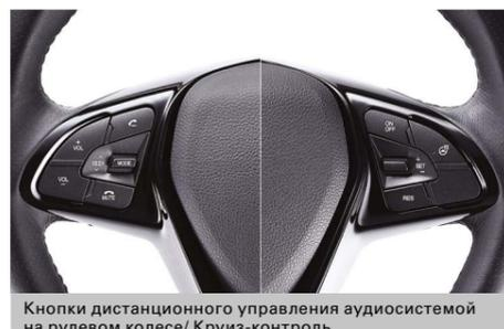
Кнопки дистанционного управления аудиосистемой на рулевом колесе/ Круиз-контроль
